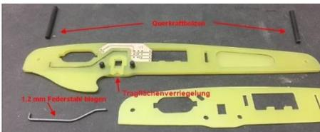
Biegen Sie den Federstahldraht unter Zuhilfenahme einer Zange zurecht, wie nebenstehend dargestellt.
