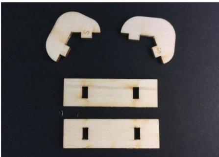
Trennen Sie die vier Einzelteile der Schleiflehre aus dem Sperrholzbrettchen mit dem Cutter heraus und verputzen diese.
