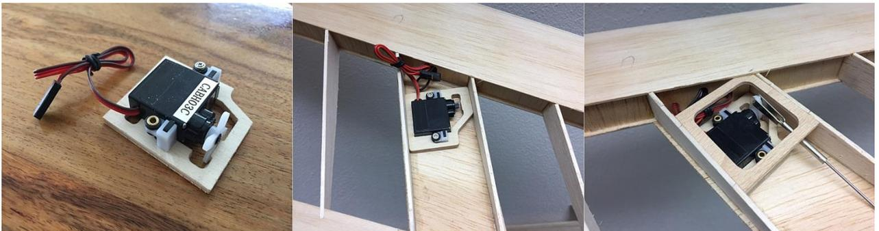
Anschließend die Beplankungsteile ebenfalls mit Weißleim aufkleben und überschüssigen Klebstoff mit einem Wattestäbchen aus der Sicke putzen damit der Servodeckel später plan zum liegen kommt.
