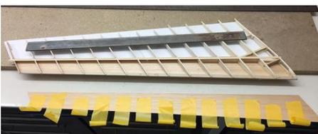
Setzen Sie nun die obere Beplankung direkt an den Rippenkanten hinter dem oberen Tragflächenholm L1 an und fixieren Sie diese mit Stecknadeln.
