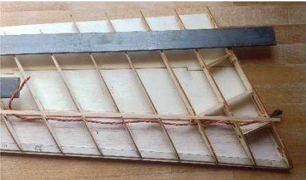
Fädeln Sie das sechspolige Servo Verlängerungskabel, ausgehend von der Wurzelrippe, durch die ovalen Rippenbohrungen bis Sie zwischen den Rippen 7 und 8 angekommen sind.
