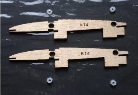
Trennen Sie die **beiden Bauteile R14** aus dem **Caiba-Sperrholzbrettchen P12** und verputzen Sie die Trennstege.
