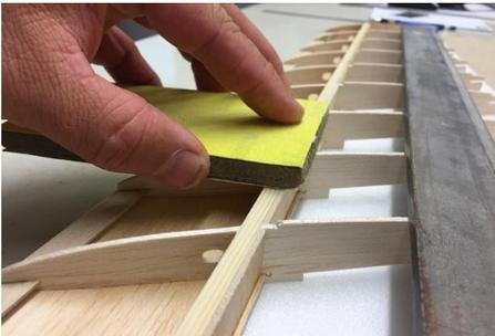
Egalisieren Sie mit der Schleifleiste den Übergang zwischen dem oberen Tragflächenholm L1 und der im vorigen Bauabschnitt angebrachten Holmverkastung.
