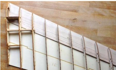
Schieben Sie nun den **unteren Tragflächenholm L1** in die ausgearbeiteten Ansträgungen der Rippen ein.
