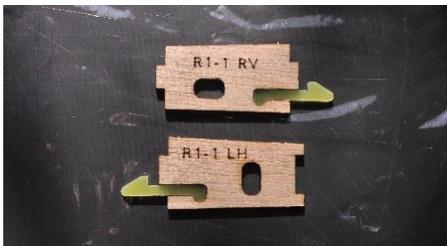
Verkleben Sie die beiden GFK-Laschen in die **Bauteile R1-1 RV und R1-1 LH**, wie nebenstehend abgebildet mit dünnflüssigem Sekundenkleber.
