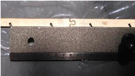
Fügen Sie die beiden **Teile N1 und N2** der Nasenleiste auf dem Baubrett zusammen und verkleben sie mit dünnflüssigem Sekundenkleber.
