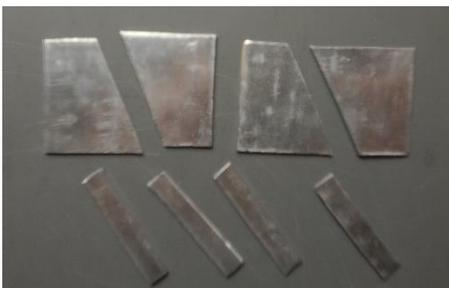
Glätten Sie die Teile mit dem Rundholz, wie zuvor beschrieben und zertrennen Sie die 8 mm breiten Streifen in 40 mm lange Abschnitte.
