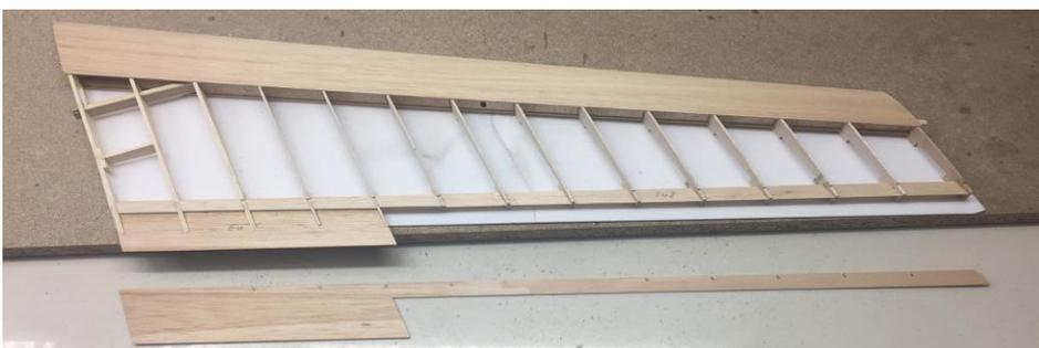
Wenn alles passt, kann die obere Endleistenbeplankung mit Weißleim aufgeklebt werden. Zum Schutz des Balsaholzes im Endleistenbereich empfiehlt sich Balsaholzreste beim Zusammenpressen beizulegen.
