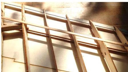
Setzen Sie nun die **vorbereitete Nasenleiste** in die entsprechenden Aussparungen der Rippen ein. Sie sorgt für die korrekte Ausrichtung der Rippen.
