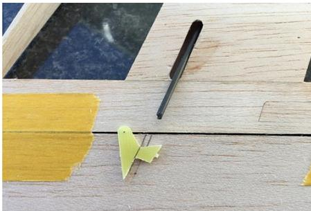
Als nächster Schritt sind die Ausnehmungen für die GFK Ruderhörner in den Balsa Querrudern dran. Hierzu wird zeichnerisch die Flucht der CFK Stange auf die Querruder verlängert.
