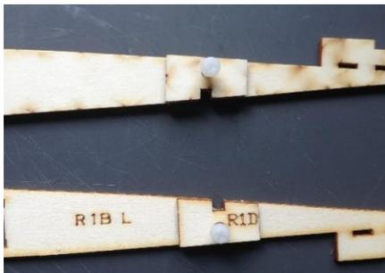
Kleben Sie mit Weißleim die beiden hinteren **Verstärkungen R1D** auf die beiden **Wurzelrippen R1B R und R1B L**.
