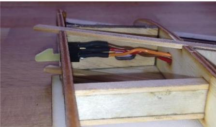
Passen Sie die Buchsenleiste in die entsprechende Öffnung der Wurzelrippe ein.
