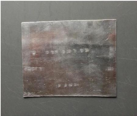
Eventuelle Unebenheiten können Sie einfach beseitigen, indem Sie das Blei auf eine ebene Unterlage legen und mit einem Rundholz einige Male kreuz und quer mit leichtem Anpressdruck darüberrollen.
