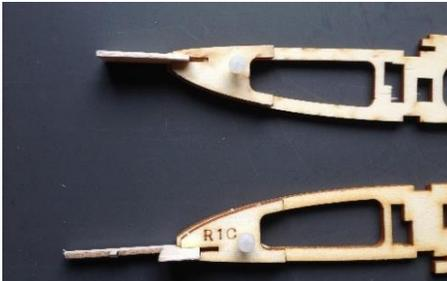
Kleben Sie mit Weißleim die beiden vorderen **Verstärkungen R1C** auf die beiden **Wurzelrippen R1B R und R1B L**.
