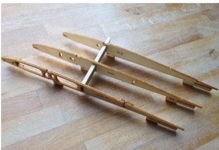
Nehmen Sie die **vorbereitete Wurzelrippe R1B R** sowie die beiden **Rippen R2R und R3** (von links nach rechts).
