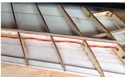
Positionieren Sie die **Füllstücke 2-3 bis 4-5** in den entsprechenden Rippenfeldern vor den beiden Tragflächenholmen und verkleben Sie diese mit dünnflüssigem Sekundenkleber.
