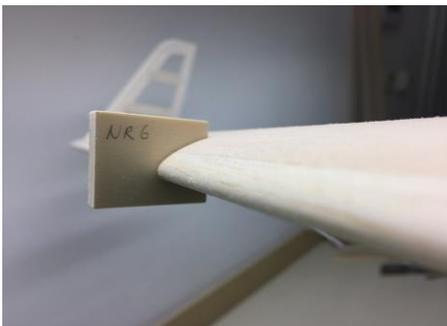
Mit Hilfe der Nasenradiuschablonen wird die Nasenleiste verschliffen. Hierbei entspricht die Bezeichnung auf den Schablonen den jeweiligen Positionen an den entsprechenden Rippen. Also wird z.B. die Schablone NR6 bei der Rippe 6 angelegt. Die **Schleifschablonen sind dabei immer in Flugrichtung anzulegen**, nicht senkrecht zur Nasenleiste!
