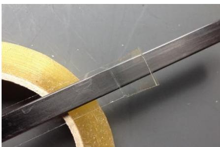
Bekleben Sie eine Seite des CFK Steckungsstabs mit einer Lage TESA Film.
