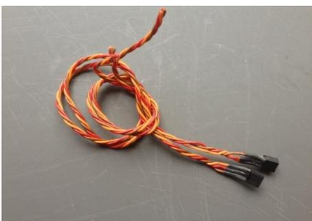
So sehen die beiden vorbereiteten Servoverlängerungskabel aus, die in einem späteren Bauschritt in die Tragflächenhälften eingebaut werden
