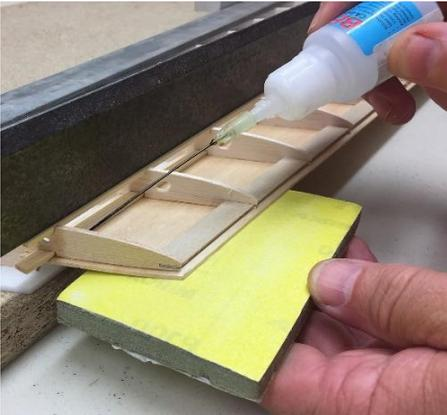
Nach dem Trocknen des oberen Tragflächenholms L1 beginnen Sie die Verklebung der unteren Beplankung BD-U mit dünnflüssigem Sekundenkleber.
