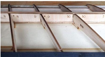
Positionieren Sie die **Füllstücke 2, 2-3 bis 13-14** in den entsprechenden Rippenfeldern hinter den beiden Tragflächenholmen L1 und verkleben Sie diese mit dünnflüssigem Sekundenkleber.
