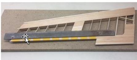
Während der Trocknungsphase die Flügel flach auf das Baubrett legen (ggf. beschweren).
