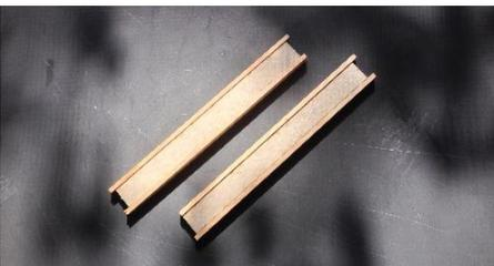
Entfernen Sie nach Trocknung des Weißleims die Klammern und die Bauteile S2 von den Steckungskästen und ziehen Sie diese vom CFK-Steckungsstab ab.
