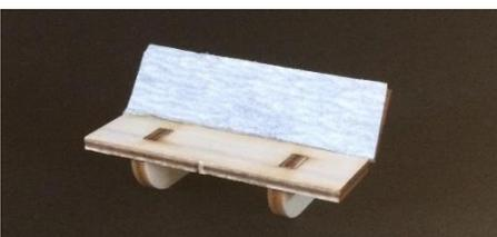
Nach dem Trocknen des Sekundenklebers kleben Sie ein Stück Schleifpapier mit Weißleim auf die entsprechend gekennzeichnete Seite der Schleifhilfe.
