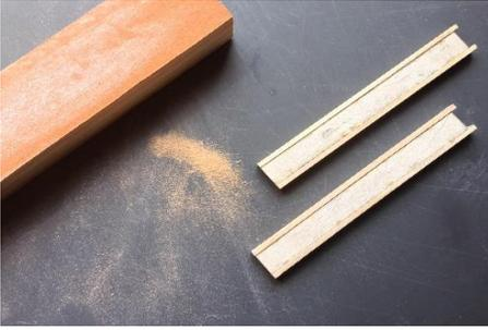
Schleifen Sie mit der Schleifleiste jeweils eine Schmalseite der beiden Steckungskästen plan. Dies reduziert den Schleifaufwand an der fertig aufgebauten Tragfläche.
