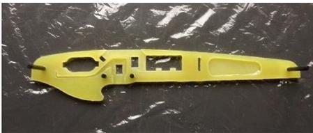
Verkleben Sie nun die beiden Teile mit UHU Endfest. Achten Sie unbedingt darauf, **im Bereich der Tragflächenverriegelung keinen Klebstoff** aufzutragen.
