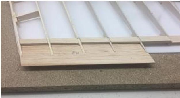
Anschließend werden aus der **5 x 10 mm Balsaleiste** die **5 Endleistenverkastungen** zwischen den **Rippen R1a(L oder R) und R6** hergestellt.
