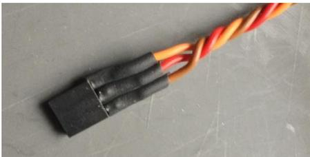
Zur Isolation können Sie vor dem Verlöten der Litzen kurze Stücke Schrumpfschlauch aufziehen und nach dem Verlöten auf die Lötverbindungen aufschumpfen.
